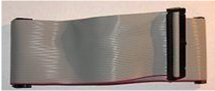
Cable IDE clásico de 40 conectores.
